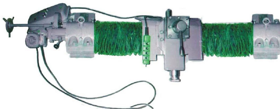
Рис. 4. Универсальный встраиваемый станок УВС-01 (А.С. №1306648) [23]
