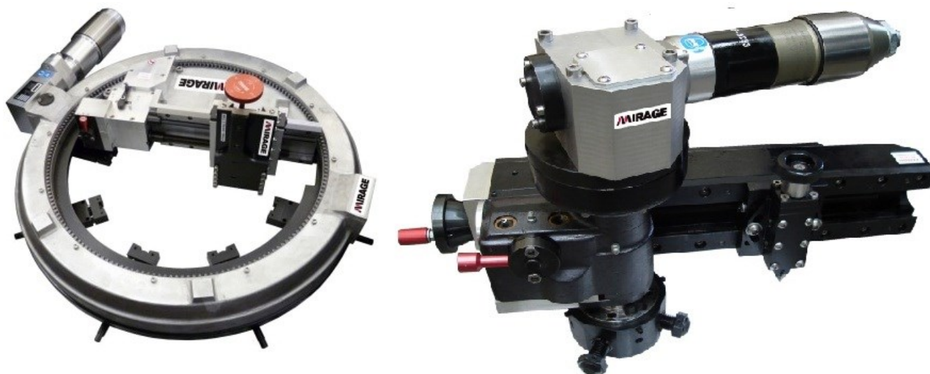
Рис. 14. Мобильные станки для обработки фланцев труб [51, 52]
